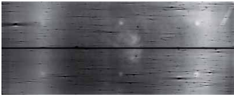
Figure 19. EL image – CIS module.
